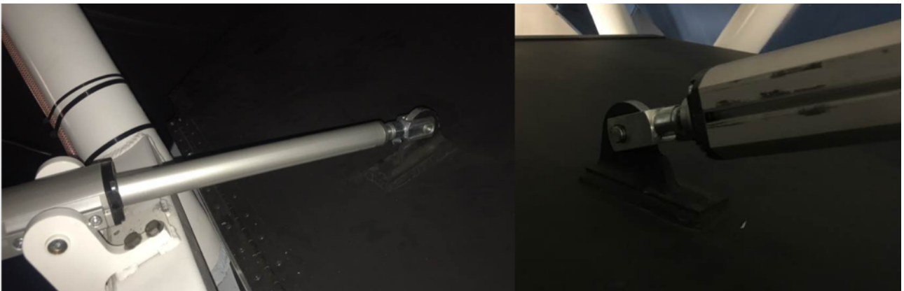
그림 1. 커버가 닫혔을 때의 정상상태(좌), 커버를 열었는데 발생한 오류(우)
